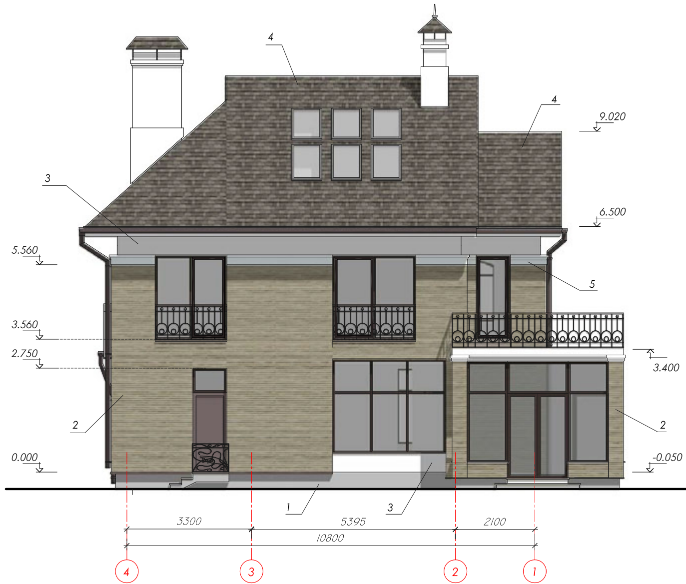
Фасад в осях 4-1
