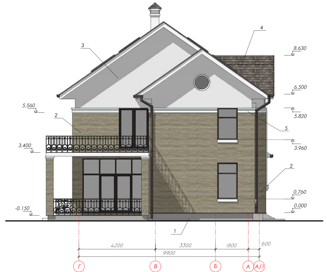
Фасад в осях Г-А/1
